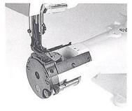
本系列是专为箱包制造业设计的筒式厚料平缝机。 坚实,造型新颖。采用滑杆挑线,立式旋梭勾线,构成 锁式线迹。上下轴用同步齿形带传动;压脚、送布牙、 同步送料;杠杆式针距调节机构。高压脚行程,高压脚 间隙和大的线迹长度,配合筒形缝台,适合于缝制厚重包 行李箱、座垫、特别适用于箱包的周边作业。
